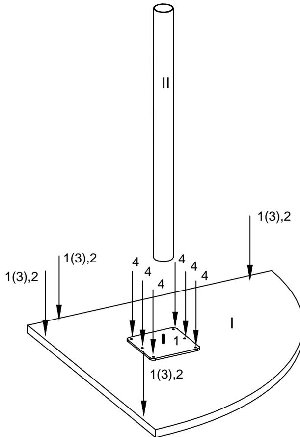
Для крепления углового элемента к столам использовать пластины крепежные (1), уголки (3), шурупы (2), предварительно отрегулировав высоту элемента углового при помощи регулируемой нижней части ноги. Рисунок текстуры столешницы (I) располагать согласно дизайн-проекта растановки столов.
