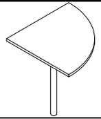
Приставку угловую рекомендуется собирать на столешнице (I). Положить столешницу (I), установить фланец крепления в требуемом месте (по оси симметрии столешницы) и закрепить 6-ю саморезами (4). Навинтить опору табуретную (II) на фланец крепления (см. рис.1).
